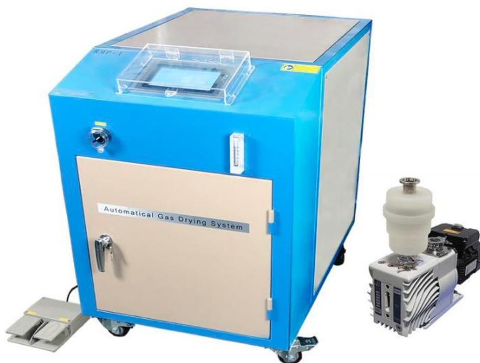
RMP-2 是一个循环水分净化系统，可为工作腔体提供一个无油，干燥的气体环境，水含量可低于 2PPM，可配合本公司手套箱使用。此款设备可为锂离子电池注液和组装提供环境。设备内部装有净化材料，在气体循环过程中，去除气体中的水分。当净化材料吸收水分饱和后，可自动对材料进行再生，恢复材料吸水能力。
