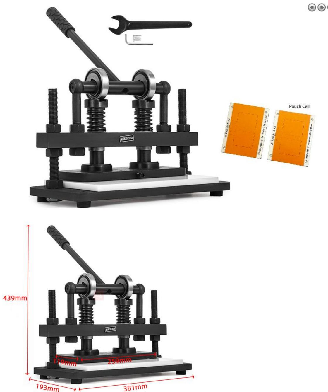
MSK-T-18 是一款手动切片机，设计用于软包电池阴极和阳极片的切割。配有一套切割刀模：1 个刀模用于切割 2 片阴极片：L56 mm x W43 mm，1 个刀模用于切割 2 片阳极片：L58 mm x W45 mm。也可按照客户要求定制刀模。这是一台低价格的实验设备，用于软包电池探索
