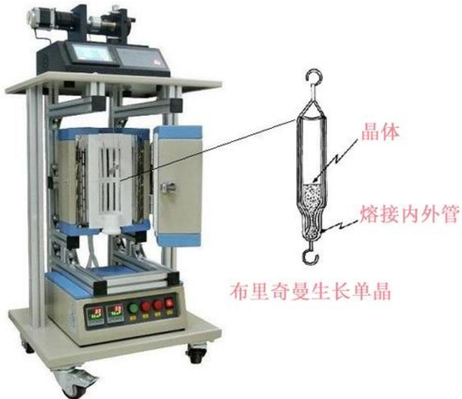
OTF-1200X-S-VT-BMGH 是一款小型的布里奇曼单晶生长炉，通过一高温金属丝提拉样品移动，此款设备适用于生长小尺寸单晶，在大气环境下或将样品密封在石英管里。
