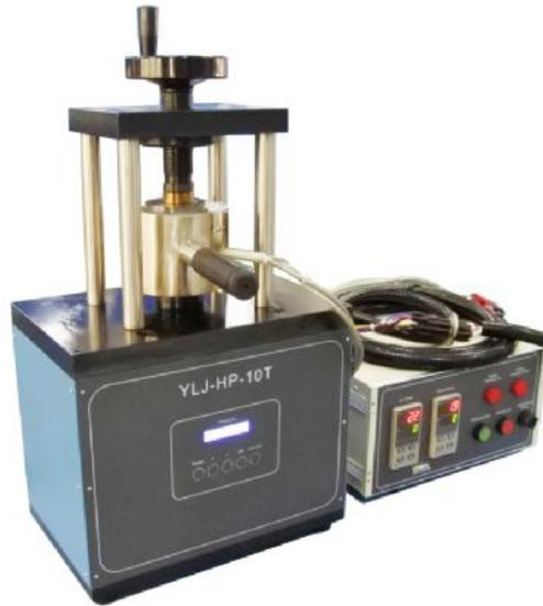
YLJ-HP-10T 是一款无油热压机，针对于晶片的焊接或薄膜转移，其可处理最大样品尺寸  $\Phi 30 \times 60\text{mm}$ 。仪器最高工作温度为  $550^\circ\text{C}$ ，在此温度下可对样品施加的最大压力为 10T(图片仅供参考，以实物为准)
