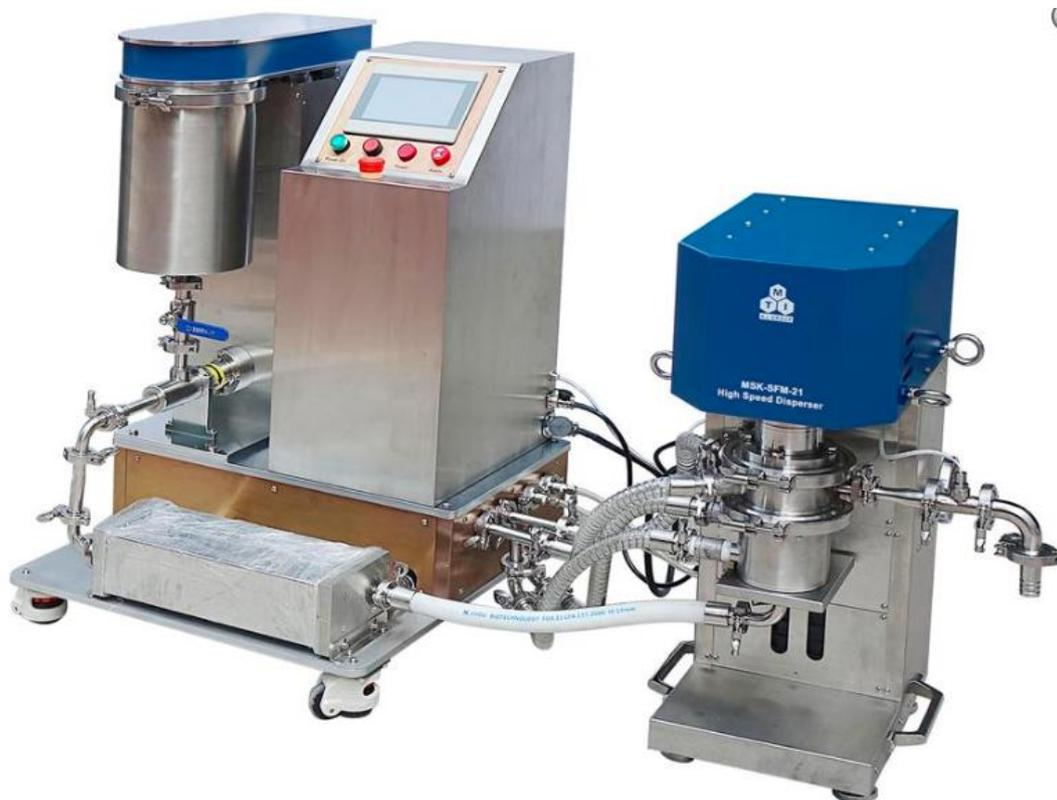
MSK-SFM-21 是一款高速浆料分散机，用于浆料更好地分散和均匀化，达到高质量的卷对卷涂布效果，特别是针对与纳米级别的材料涂布。此款设备被广泛地用于锂电池电极制备或一些陶瓷膜制备。
