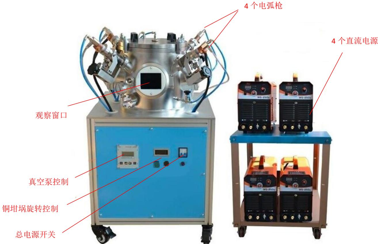
AM-400 是一款高真空电弧熔炼系统，4 个电弧熔炼枪，由 4 个独立的氩弧电源控制。水冷铜坩埚安装在真空腔体底部，可以旋转，保证合金能够均匀地熔炼，最大熔炼量为 70g(按 Fe 密度)
