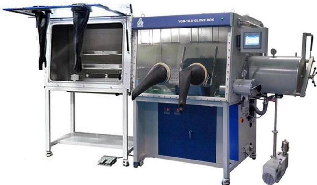
VGB-6-II-SC 是一款双连体手套箱，箱体底部带有下沉式储藏箱，可放入旋转涂覆机或小型立式设备。手套箱配有循环净化系统，可使手套箱内部  $H_2O \& O_2 \leq 1 \text{PPM}$ 。此设备设计用于制备新材料，特别适合于在无水无氧环境下制作钙钛矿太阳能电池。
