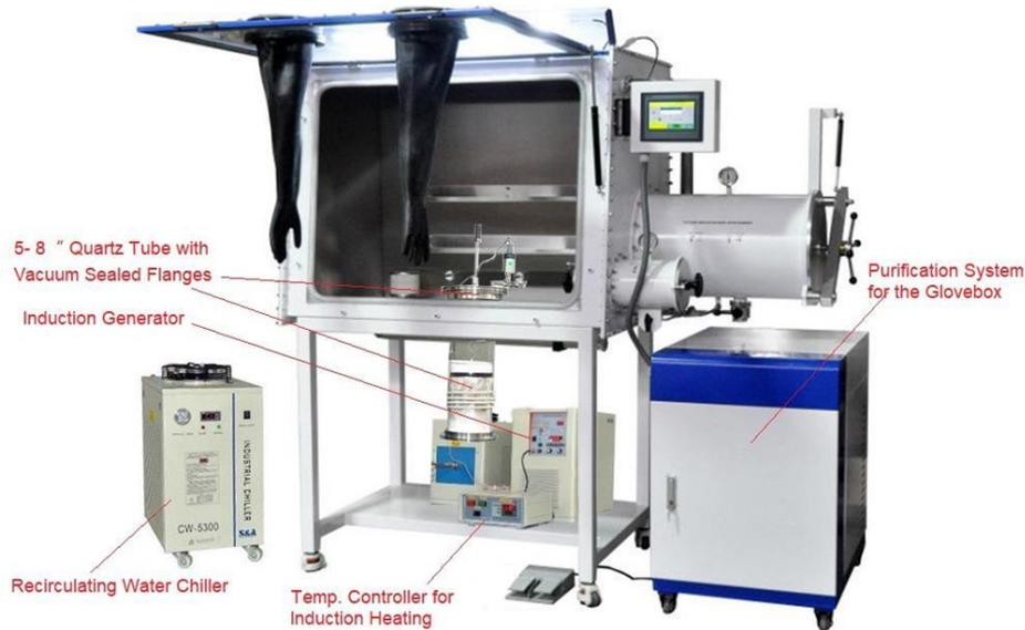
IMCS-GB1700 是一个 15KW 的感应熔炼系统,安装在带有气体净化的手套箱内 (O<sub>2</sub> & H<sub>2</sub>O < 1 ppm), 用于熔化和加工对空气敏感的金属合金。
