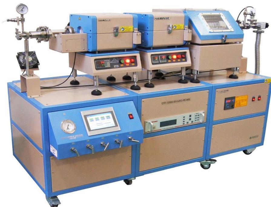
OTF-1200X-S-50-II-R-4CV-PE 是一款双温区可旋转 PECVD 系统, 组成部分为 500W 的射频电源, 旋转速度可供的双温区管式炉, 预热炉和真空系统。旋转炉 OTF-1200X-S-R-II 和预热炉 OTF-1200X-S 以电阻丝为加热元件, 采用双层壳体结构和 30 段程序控温, K 型热电偶, 炉膛采用高纯氧化铝纤维材料, 此款设备可用于生长纳米线或用 CVD 方法来制备各种薄膜。
