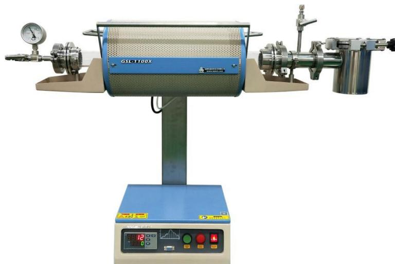
GSL-1100X-S-VTQ 是一款小型立式淬火炉，标配有  $\phi 50\text{mm}$  石英管、真空密封法兰以及样品淬火密封罐。实验时，材料可放置于石英管中，在真空或惰性气氛保护下加热到所需温度，之后手动倾斜炉体，最大倾斜角度可达  $60^\circ$ ，可方便实现淬火工艺，非常适合研究材料相变和微结构性能。
